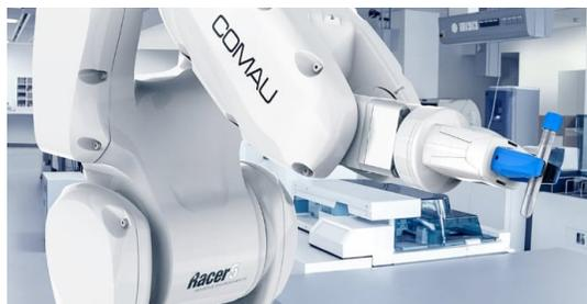
Dotato di rivestimento protettivo resistente all'acqua, al calore e al grasso, il robot a 6 assi risponde al requisito di certificazione IP67, alla classificazione di alto livello ISO 5 per camere bianche (ISO 14644-1), di protezione dagli agenti chimici e alla necessità di ridurre il rischio di contaminazione. È inoltre dotato di lubrificazione per uso alimentare NSF H1 e superfici verniciata lucida, risultando così idoneo anche per il contatto diretto con alimenti.
