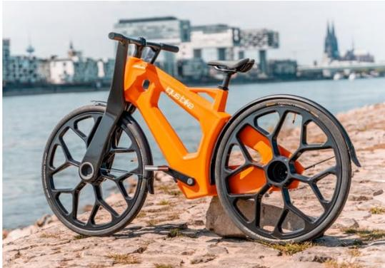
Il produttore tedesco di componenti in plastica per applicazioni industriali Iigus ha presentato alla Fiera di Hannover il prototipo di una bicicletta per uso urbano realizzata con plastica riciclata, nei suoi componenti principali (pari al 90% del totale): dal telaio ai cuscinetti, fino alla cinghia dentata che sostituisce la catena. Il materiale impiegato per la igus:bike - spiega la società - proviene dal riciclo di rifiuti post-consumo monouso.
