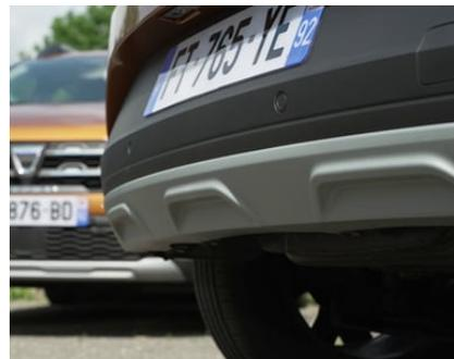
Gli elementi - in gergo tecnico ski di protezione - sono collocati sotto i paraurti anteriore e posteriore per proteggere la parte inferiore del veicolo in caso di piccoli urti; hanno anche una funzione estetica e contribuiscono a migliorare l'aspetto estetico dei paraurti.
