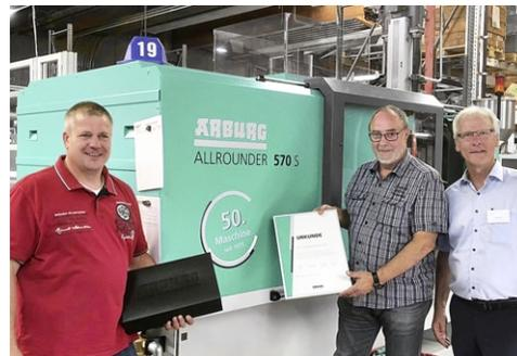
L'ultima è stata installata nelle scorse settimane presso lo stabilimento di Solingen: si tratta di una Allrounder 570 S in versione bicomponente, con forza di chiusura di 220 tonnellate, equipaggiata con tavola rotante ad azionamento elettrico e robot a sei assi.
