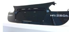
Tra le altre caratteristiche del materiale, anche buona stampabilità, resistenza all'impatto e al calore, oltre ad un basso coefficiente di espansione lineare. Rispetto al metallo largamente diffuso nelle carrozzerie delle auto, la lega termoplastica offre anche resistenza alla corrosione e leggerezza, con una riduzione potenziale del peso dei componenti del 20%.
