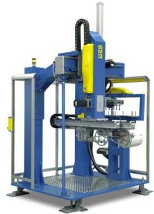
Il robot di tipo 'Side Entry', con 3 assi elettrici liberamente programmabili e una rotazione sul polso per il ribaltamento dei particolari prelevati nello stampo. In grado di lavorare sia in spalla fissa che in spalla mobile, XSeries SM3 può essere accessorizzato per stampi stack mould o adattato per l'etichettatura nello stampo (IML), come pure per applicazioni di assemblaggio o packaging, grazie a moduli standard facilmente integrabili.
