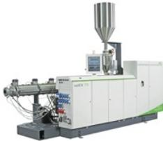
Il secondo estrusore esposto al Plast sarà il modello monovite solEX 75-40 (foto a sinistra), con diametro vite di 75 mm e L=40D, studiato in modo particolare per l'estrusione di tubi in HDPE e PP. La gamma comprende versioni con diametro vite da 45 a 120 mm e capacità produttiva fino a 2.200 kg/ora.
