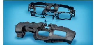
La plancia in espanso microcellulare pesa circa mezzo chilo meno di una tradizionale, pur mantenendo - e addirittura migliorando - le proprietà meccaniche, con una riduzione dei tempi di ciclo del 15%. A parità di dimensioni, inoltre, la forza di chiusura della pressa può essere ridotta del 45%, con un risparmio di circa 3 dollari per veicolo rispetto alla precedente soluzione in materiale plastico compatto.
