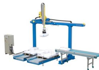
L'impianto prevede due postazioni di alimentazione pallet; questi ultimi vengono posizionati dall'operatore tramite carrello elevatore su rulliera folle. Le operazioni di depallettizzazione sono rese sicure da protezioni antinfortunistiche dotate di porta controllata per accesso operatore e aperture controllate per il posizionamento dei pallet in zona di prelievo. Sensori di livello posti sulla tramoggia di deposito provvedono all'attivazione del ciclo di carico.
