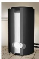
Sempre al Bau, BASF presenta in questi giorni anche alcune applicazioni della schiuma melamminica a celle aperte Basotect, tra cui l'isolamento esterno di boiler per acqua calda con capacità fino a 500 litri. Il materiale possiede infatti buone caratteristiche di isolamento termico (0,035 W/mK), resiste alla fiamma e a temperature fino a 240°C. In questo tipo di applicazione, l'espanso spesso tra 50 e 115 mm viene rivestito con una pelle di polistirene.
