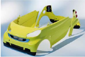
Grazie alla pigmentazione in massa, le fasi di finitura post-assemblaggio si riducono all'applicazione di un unico strato di rivestimento protettivo trasparente. Secondo Borealis, questa soluzione consente di ottenere una finitura piÃ¹ omogenea e liscia della vernice. Il peso dell'intero veicolo, con l'adozione delle resine Borealis,Â risulterebbe inferiore del
