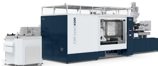
Utilizzando uno stampo a 128 cavità sviluppato da z-moulds e periferiche Intravis, l'impianto è in grado di operare con un tempo di ciclo di soli 1,9 secondi.
