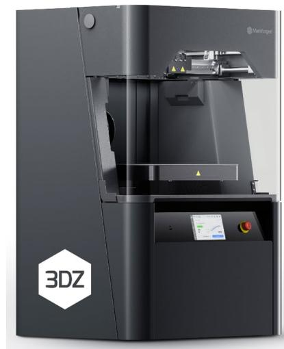
La stampante a filamento con rinforzo in fibra continua (tecnologia CFR) ha un volume di stampa di 375 x 300 x 300 mm e si caratterizza per un sistema di cambio automatico del materiale che riduce i tempi di ciclo, calibrazione automatica del piano e micrometro laser che scansiona in tempo reale, garantendo precisione e affidabilità in ogni stampa.
