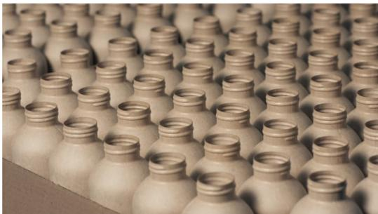
La danese Paboco ha deciso di passare alla produzione su scala industriale della "paper bottle", una bottiglia in fibra di cellulosa rivestita internamente con un liner barriera in plastica o bioplastica.
