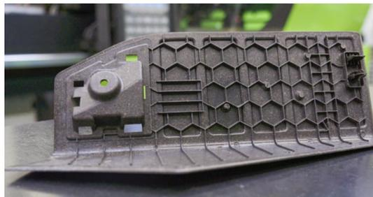
A questo fine, è stato avviato nel 2020 in Spagna e in Germania il progetto di ricerca COMPOlive, che ha portato allo sviluppo di biocompositi costituiti da polipropilene riciclato rinforzato con il 40% di fibre vegetali, e - recentemente - alla realizzazione di alcuni prototipi, come come poggiatesta e rivestimenti del bagagliaio.
