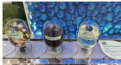
Battezzato TAC (Thermal Anaerobic Conversion), il processo messo a punto da Plastic Energy genera un olio di pirolisi denominato Tacoil, che può essere trasformato in biocarburanti o materie prime riutilizzabili nella sintesi di polimeri e specialità chimiche.
