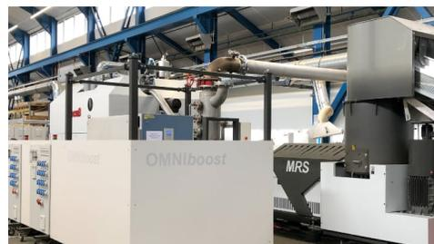
Il sistema di riciclaggio OMNIboost (foto a destra) è invece progettato in modo specifico per il riciclo di PET. Il reattore integrato JUMP porta il valore di viscosità intrinseca IV al livello desiderato in pochi minuti, consentendo il passaggio diretto in produzione.
