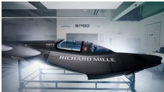
Exolon Group ha fornito lastre compatte in policarbonato, spesse 12 millimetri, termoformate dall'azienda francese Vitalo/Starplast, per realizzare il pozzetto (cockpit) della Speedboat SP80, che quest'estate effettuerà il primo test di navigazione sulla costa francese del Mediterraneo con l'obiettivo di battere il record mondiale di velocità per barche a vela.
