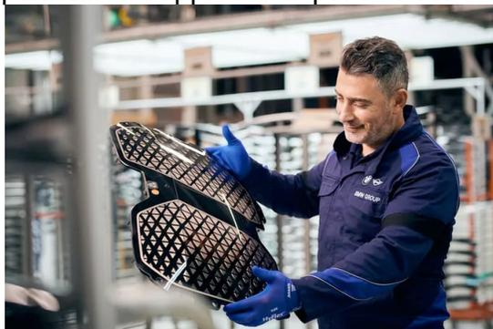
Questi componenti, che sostituiscono le griglie radiatore dei modelli a combustione termica, hanno lo scopo di proteggere una serie di sensori per la guida assistita e, in futuro, anche per quella autonoma. Per garantire che i sensori funzionino in modo affidabile anche in inverno, BMW retroinietta un film funzionale riscaldabile a base di policarbonato, quindi riveste il componente con poliuretano. L'elettronica sensibile resta così protetta sotto lo strato in poliuretano antigraffio, mentre la
