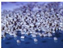
I prodotti saranno forniti inizialmente in versione tal quale, con due gradi di viscosità nella forma di granuli e polvere, e in tre compound pronti all'uso: uno rinforzato con il 30% fibra vetro (Vestakeep GF30), il secondo con il 30% fibra di carbonio (Vestakeep CF30) e il terzo con rinforzo di fibre di carbonio, grafite e aggiunta di PTFE, tutti in concentrazioni del 10% (Vestakeep FC30). Per alcuni compound, afferma la società, sono già state ottenute le certificazioni UL e FDA.
