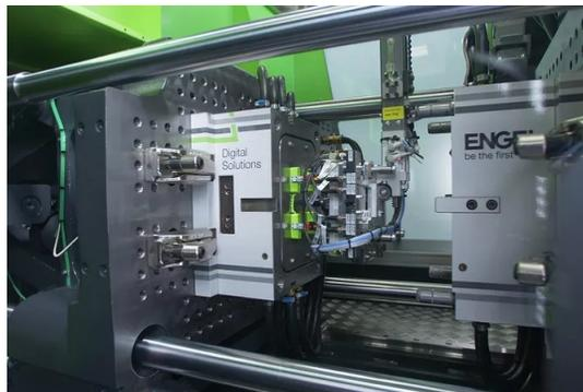
L'isola si basa su una macchina con forza di chiusura di 80 tonnellate e stampo a quattro cavità per la produzione di porta connettori auto in PBT (foto sotto), ognuno del peso di 28 grammi, con un consumo specifico pari a 0,8 kWh per chilogrammo di materiale, senza pregiudicare precisione e ripetibilità. La cella è completa di robot lineare Viper per la rimozione dei pezzi dallo stampo e il posizionamento su nastro trasportatore.
