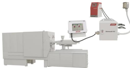
Nel processo Airmould, gas di azoto viene iniettato nello stampo parzialmente o completamente riempito con materiale plastico fuso, generando così una cavità interna che consente di alleggerire il pezzo senza pregiudicare la qualità superficiale, con tempi di ciclo ridotti e risparmio di materia prima. Wittmann propone questa tecnologia dagli anni '80 del secolo scorso, producendo internamente le attrezzature presso lo stabilimento di Meinerzhagen.
