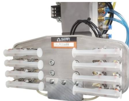
Cuore dell'isola è la pressa BMB eKW16Pi full electric equipaggiata con uno stampo a otto cavità del costruttore tedesco Ruhla, con esperienza ventennale nel settore medicale. Il pezzo stampato sarà rimosso dal robot high-speed ZXW-1000VI di Star Automation Europe, dotato di ventose VAPH, con tempo di estrazione di circa 1 secondo su un ciclo totale che si aggira sui 5 secondi. In presenza di stack mould, il robot consente l'implementazione di un secondo asse verticale.
