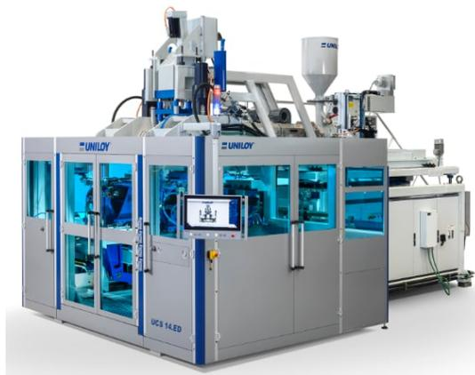
Gli impianti per estrusione-soffiaggio UCS.E sono dedicati alla produzione in costruzione fino a 7 strati di bottiglie, flaconi, contenitori e articoli tecnici con capacità da 50 ml fino a 30 litri, utilizzando la quasi totalità di resine commerciali, comprese bioplastiche e riciclati.
