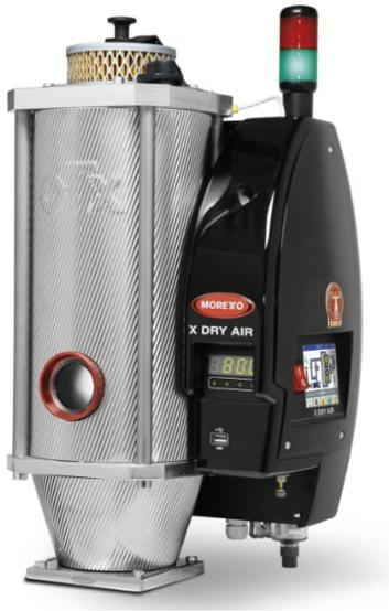
Il restyling ha interessato anche la serie di mini dryer Dry Air (foto a sinistra), che ora montano la tramoggia OTX e un display touch semplificato. È un modello con circuito a doppia torre e regolazione manuale dell'aria di processo, ideale per il trattamento di polimeri tecnici, disponibile in 6 diverse grandezze.
