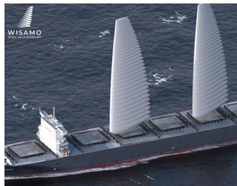
L'idea è quella di realizzare grandi vele gonfiabili con profilo alare segmentato, montate su bracci telescopici e controllate da un sistema computerizzato che ne automatizza il funzionamento. Per spiegare le vele è sufficiente insufflare all'interno aria a bassa pressione, mentre per ammainarle basta sgonfiare la struttura.
