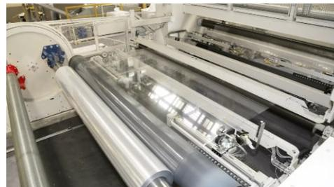
L'impianto Mopet-G a 3 strati, che entrerà in funzione alla fine del 2022, presenta una larghezza di 4,2 metri e una capacità produttiva pari a 6.600 tonnellate annue di film termoretraibile con spessore compreso tra 20 e 70  $\mu\text{m}$ , destinato ad applicazioni di packaging, come sleeve, imballi a prova di manomissione ed etichette.
