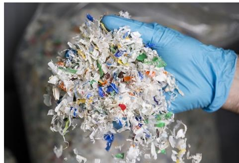
Dal trattamento chimico di rifiuti plastici misti si ottengono feedstock utilizzati da Total nello steam cracker di Anversa per produrre etilene, da cui si ricava 'polistirene circolare' con caratteristiche identiche a quelle del polimero vergine, quindi adatto per applicazioni a contatto con alimenti. La quantità di materia prima seconda allocata per produrre rPS è certificata con lo schema ISCC Plus, che accompagna il materiale lungo tutta la filiera, fino al prodotto finito.
