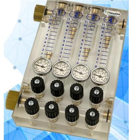
In dettaglio, Serie 1M è un flussometro monoblocco in 2 moduli, a 4 e 6 vie, destinato alle vasche di raffreddamento di linee di estrusione con collettore di mandata, regolazione flusso con valvole in ottone e misurazione della portata dell'acqua. Facilmente adattabile agli estrusori Battenfeld-Cincinnati, questo modello si affianca alla Serie 1R progettata per regolare e misurare l'acqua di ritorno.
