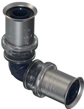
Wavin ha introdotto sul mercato dell'idrotermosanitaria Tigris K5, versione in tecnopolimero (PPSU) della gamma di raccordi in ottone per tubi multistrato, che presenta tra le sue caratteristiche un allarme acustico (mediante un fischio di circa 80 decibel) che segnala all'installatore la mancata pressatura in fase di collaudo con aria.
