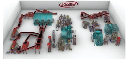
Le linee che tratteranno bottiglie leggere, con alte percentuali di PVC ed etichette termoretraibili non in PVC, saranno dotate di un De-Labeller Amut a doppio stadio per la rimozione delle etichette: nella prima fase esegue un lavaggio a secco, staccando così la maggior parte delle etichette termoretraibili, mentre la seconda unità opera a umido, come prelavaggio a freddo, permettendo di rimuovere i contaminanti, senza danneggiare le bottiglie ed evitando di perdere i colli durante il processo.
