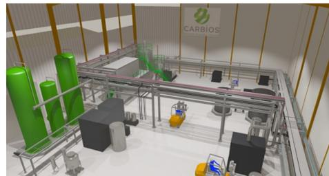
L'unità pilota servirà per ottimizzare il processo in vista della realizzazione di impianti su scala industriale, su licenza, con capacità tra 50mila e 100mila tonnellate annue. Sarà realizzata da TechnipFMC nei pressi di Lione ed entrerà in funzione, secondo programma, nel giugno del 2021. L'impianto produrrà anche lotti per valutare, a livello applicativo, le proprietà e le prestazioni ambientali ed economiche dei monomeri ottenuti dal processo di riciclo biologico.
