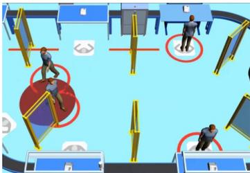
Il sistema - grazie ai moduli Simomatix Process Simulate e Plant Simulation - consente inoltre di allestire un 'digital twin' (copia digitale della fabbrica) che consente di simulare il livello di sicurezza dei lavoratori, ottimizzare i layout del reparto e validare le misure di sicurezza adottate.
