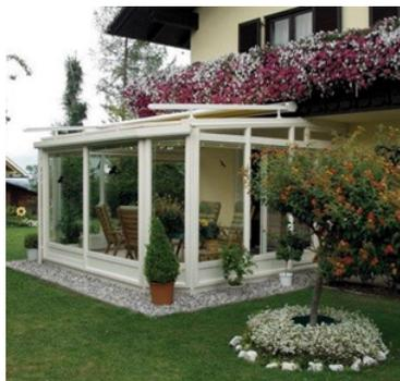
La scelta del PVC nel telaio è legata alle sue riconosciute caratteristiche di resistenza, indeformabilità, leggerezza ed eccellenti proprietà isolanti. Il PVC non richiede alcuna opera di manutenzione, se non la normale pulizia, non provoca condense e non viene attaccato dagli agenti atmosferici. Ed è completamente riciclabile alla fine del suo utilizzo.
