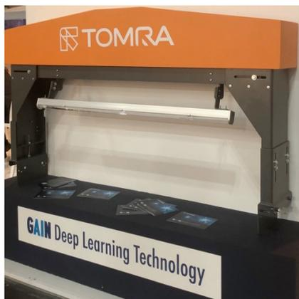
Il sistema Gain sarà fornito come componente aggiuntivo delle linee di selezione ottica Autosort (processo combinato che rileva materiale e colore assieme alla granulometria) e consentirà di selezionare oggetti che prima non potevano essere identificati, ottenendo così un prodotto finale più puro, senza diminuire la velocità di selezione.
