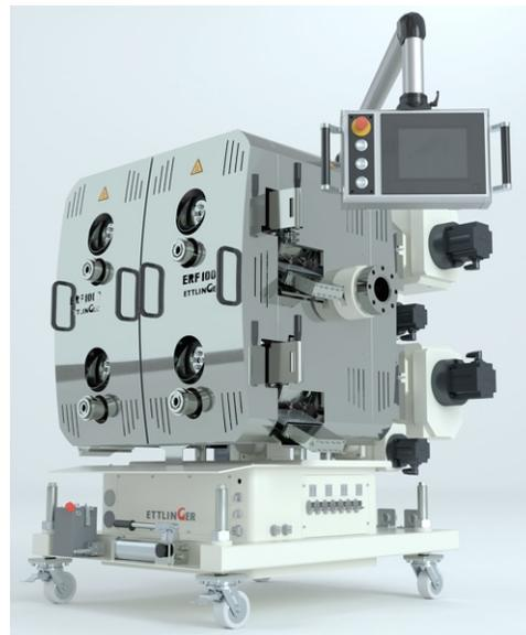
I suoi quattro cesti filtranti - spiega l'azienda tedesca - offrono una superficie di filtrazione totale di 6.280 cm<sup>2</sup>, il doppio rispetto al precedente modello top di gamma ERF 500, separando dalla massa fusa le materie estranee con una percentuale di contaminanti fino al 18 %. Nonostante la potenza, l'apparecchio presenta un design compatto ed un ingombro ridotto.
