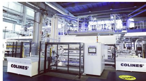
Secondo quanto afferma il costruttore, la linea, equipaggiata con sette estrusori per film a 9 strati di larghezza 3.000 mm, vanta una produzione netta pari a 2.100 kg/h ed una velocità operativa fino a 750 metri al minuto.
