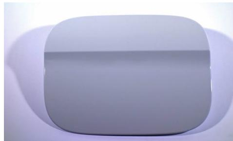
La soluzione in PBT è stata adottata sulla nuova Skoda Scala, in cui lo sportellino è realizzato con Pocan B5221XF (Xtreme Flow), grado ad alto scorrimento rinforzato con il 20% di microsfere di vetro, che può essere sottoposto insieme alla carrozzeria all'intero processo verniciatura elettrostatica, grazie alle proprietà ottimizzate di adesione ai pigmenti e di resistenza alle alte temperature di breve durata (HDT di 165°C), contribuendo alla riduzione dei costi di produzione.
