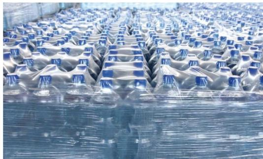
Il primo grado sul mercato, Repsol 50RX2805, è un polietilene a bassa densità lineare (LDPE), contenente il 50% di plastica riciclata post-consumo, destinato alla produzione di film termoretraibile per fardellaggio multi-pack di bottiglie, lattine, flaconi e cartoni.
