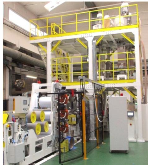
L'impianto per estrusione diretta monta un coestrusore bivate cortante MCM 60, unità di dosaggio gravimetrico e, a fine linea, un gruppo di calandratura a tre rulli con avvolgimento automatico. Completa anche la dotazione sensoristica ed elettronica per la verifica in continuo della qualità, della precisione e della sicurezza degli operatori, sia nel movimento della calandra che per il controllo dello spessore in linea.
