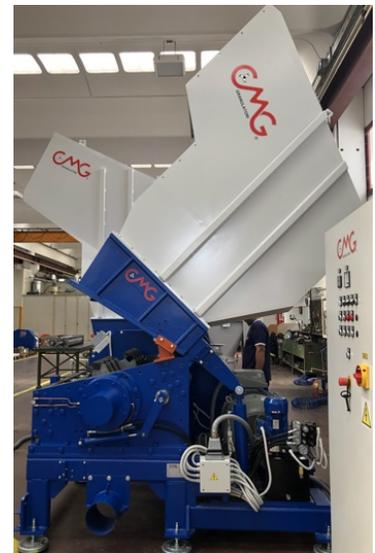
**TRITURATORI E GRANULATORI.** La gamma di macchine in portafoglio comprende nove diverse serie, dai piccoli granulatori bordo pressa con capacità di 30-50 kg/h - robusti e compatti - per arrivare ai modelli della serie Evoluzione adatti per lavorare in continuo e capaci di trattare migliaia di chilogrammi di rifiuti plastici ogni ora (il modello EV616 tocca i 5.000 kg/h), o ai trituratorini per il
