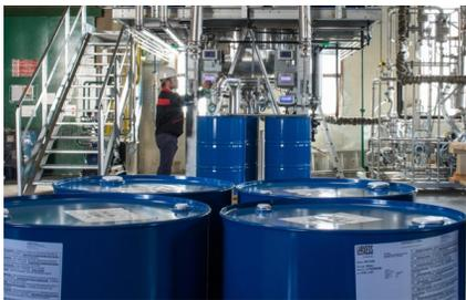
PILOTA PER LOW-FREE. Fiore all'occhiello del polo laziale è l'impianto pilota utilizzato per lo sviluppo di pre-polimeri uretanic, dotato di un sofisticato sistema per l'estrazione, mediante vuoto, dei residui di monomero libero (isocianato), causa dei VOC (composti organici volatili).
