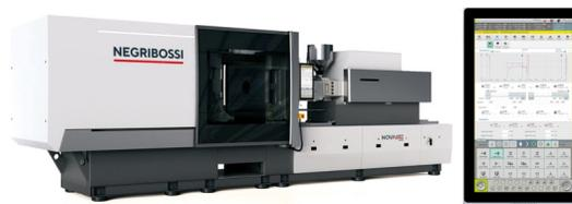
La serie ad azionamento completamente elettrico Nova eT è disponibile con forza di chiusura da 50 a 350 tonnellate. Tra le caratteristiche si segnalano lo scorrimento della piastra mobile su cuscinetti lineari lubrificati in automatico, così da garantire la massima pulizia dell'area di lavoro, precisione e risparmio energetico, nonché la completa sovrapposizione dei movimenti, al fine di abbreviare il tempo ciclo. Le macchine sono dotate del nuovo controllo Tactum Multitouch.
