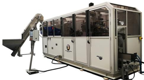
Meccanoplastica Ibérica, divisione Stretch Blow Moulding del gruppo toscano Meccanoplastica, ha introdotto in catalogo il nuovo modello MiPET 2PN per stiro-soffiaggio di preforme PET con produttività oraria fino a 4.000 contenitori e consumo medio intorno a 20 Kwh con stampo a doppia cavità (2,5 litri). Senza dubbio una delle macchine più veloci oggi disponibili.
