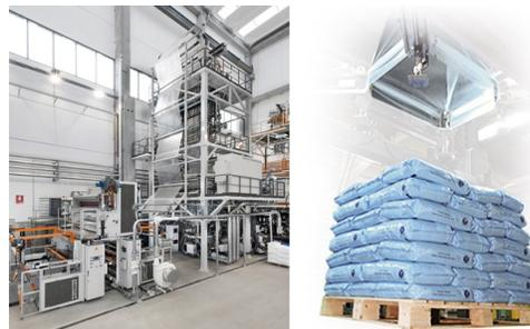
Dopo una linea completa per estrusione a testa piana ed una per la granulazione di PVC, sarà presto avviata a Pyeongtaek una terza linea per film in bolla della serie SmartFlex, di nuova generazione, con tavola da 1.800 mm, dedicata principalmente alla produzione di film per stretch hood, nonché film per stampa e laminazione.
