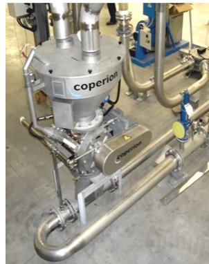
LINEA COMPLETA IN NORD ITALIA. Uno dei più recenti pro riguarda un compoundatore del Nord Italia, presso il quale Coperion installando una linea completa, dopo averne allestite due simili in L'impianto comprende un estrusore bivate Coperion della serie ZS produttività pari a circa 1.000 kg/h, integrato a monte con l'alime automatica dei materiali e, a valle, vasca di raffreddamento, taglie pellettizzazione e insacco. Il tutto gestito da un unico sistema di ottica Industria 4.0.
