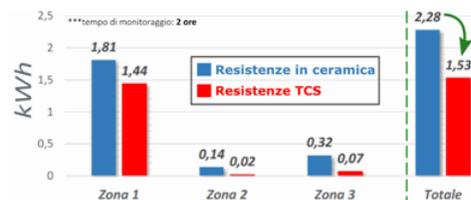
Un risultato - spiega il distributore italiano del sistema TCS - frutto della combinazione tra le proprietà della coibentazione in ceramica e la modalità di scambio termico, l'irraggiamento, che consente di generare la medesima potenza termica a fronte di un minor consumo e di
