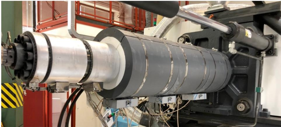
Per dimostrare l'efficacia delle resistenze radianti coibentate TCS nel riscaldamento del cilindro di plastificazione, l'italiana Mohwinckel - che le distribuisce nel nostro paese - ha condotto presso il Consorzio Proplast uno studio comparativo sui consumi energetici rispetto a sistemi di riscaldamento convenzionali.
