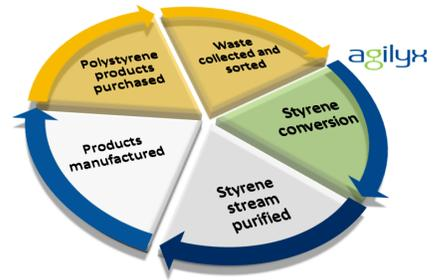
Il processo sviluppato da Agilyx prevede la depolimerizzazione di rifiuti misti contenenti polistirene, trasformati in stirene monomero liquido riutilizzabile per ottenere polistirene senza scadimento delle proprietà fisico-meccaniche.
