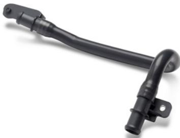
Il nuovo PPS per estrusione è disponibile nei tre gradi Ryton XE3500BL, XE4500BL e XE5500BL, con rigidità compresa tra 1500 e 2500 MPa per soddisfare le differenti richieste nel settore dei tubi flessibili per refrigeranti in termini di spessore parete e diametro, oltre che per l'eventuale termoformatura dopo l'estrusione. I gradi per stampaggio sono invece Ryton XE5430BL e R-4-270BL, rispettivamente con il 30% e il 40% di rinforzo con fibra vetro.
