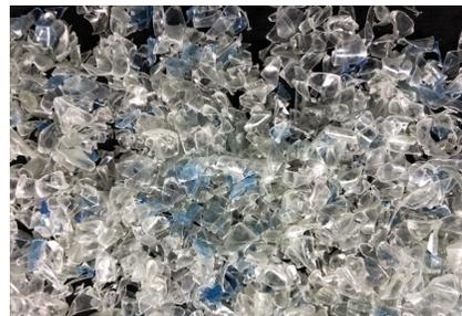
Il PET rigenerato utilizzato nella formulazione di Viridis 25 è ottenuto mediante riciclo chimico di flakes post-consumo, tecnologia già validata e ora pronta per il passaggio su scala industriale. Secondo l'azienda tedesca, a regime la produzione del nuovo grado assorbirà un volume pari a 30mila tonnellate di rPET, equivalente al 3% di quello oggi disponibile in Europa.
